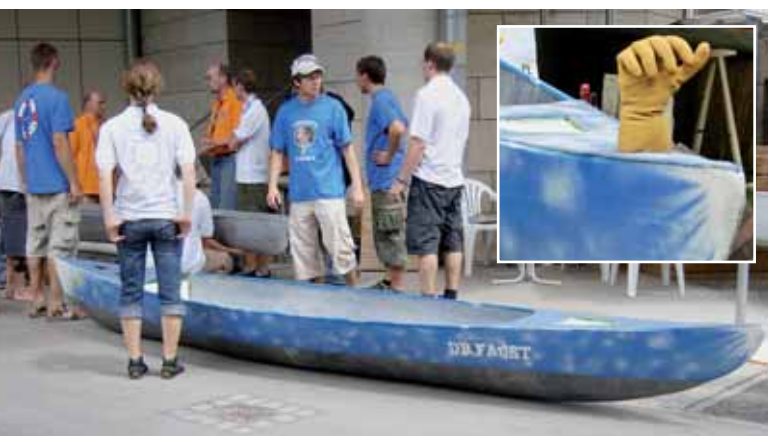
Das Kanu „Orthopedo“ (oben) besteht aus zwei Teilen, die mit einem Gelenk aus Beton (rechts) verbunden sind.
