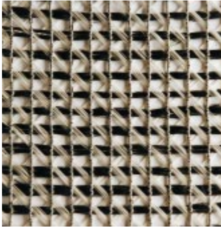
Bild 2: Verwirktes multiaxiales Gelege (WIMAG) aus alkaliresistenten Glasfaser- und aus Kohlefasergarnen (Kanu „WiMagie“) Foto: Jochim
