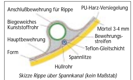
Bild 9: Betonrippe über Spannkanaal (Systemskizze) Graphik: Buscher
