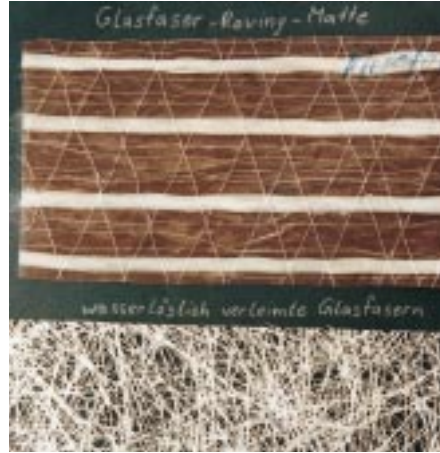
Bild 3: Glasfasern: Rovingmatte, wasserlöslich verleimte Matte (Kanu „Flotter Goethe“) Foto: Jochim
