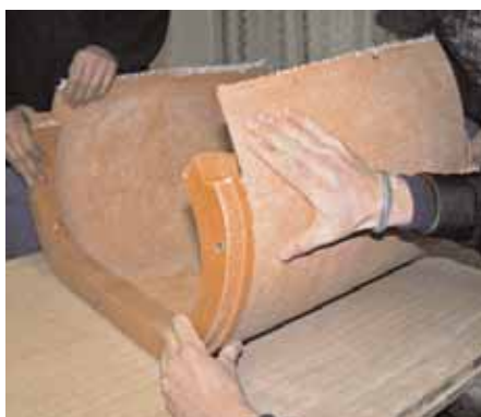
Hauchdünn und biegsam: Die Studenten bewiesen, dass Beton keinesfalls starr und unnachgiebig sein muss.
