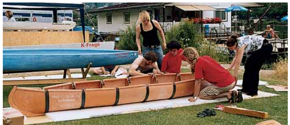
„rumLappen“: Elf „Lappen“ aus Beton wurden für das Kanu auf Betonspannen aufgezo- gen und mit Spanngurten angepresst.
