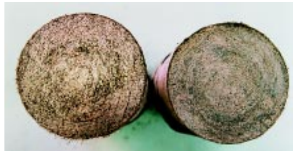
Bild 5: Geschliffene Endflächen der Druckfestigkeitsprüfkörper
