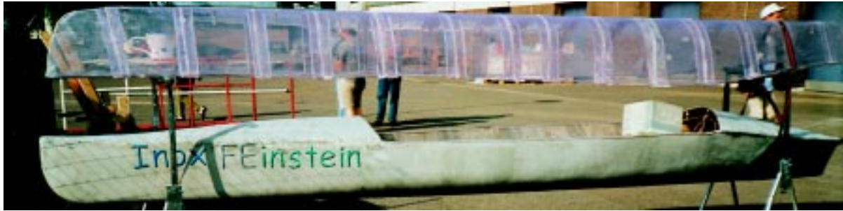
Bild 17: Das Betonkanu „Inox FEinstein“ mit transparenter PVC-Innenschalung (Foto: Lorenz)
